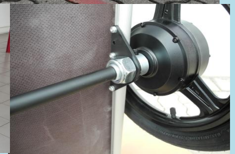
M24 mm Achsmutter SW 36 18 mm Achse
