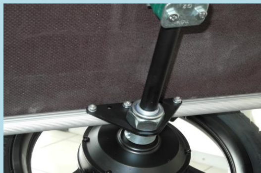
M 24 Radaufnahme mit Bodenbefestigungen
