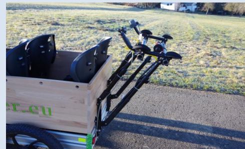
X- fach verstellbare Armauflagen mit stufenlosem Handgas und stufenloser Reku-Bremse
