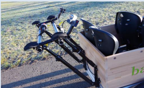
X- fach verstellbare Armauflagen mit stufenlosem Handgas und stufenloser Reku-Bremse
