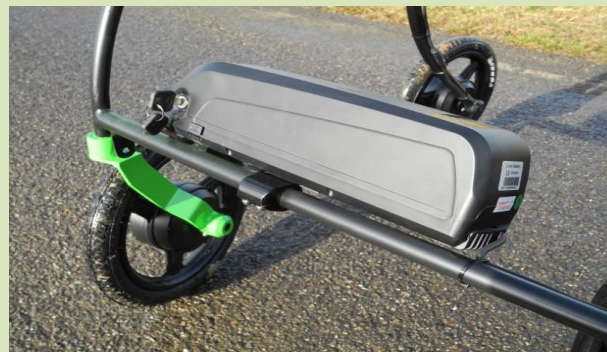
Der 36/42 Volt Akku sorgt für Reichweiten über 40 km und ist abschließbar und abnehmbar. Leistung 300 bis 440 Wh (Wattstunden) Mit Ladegerät 230 V- 80 Watt. Einfach ladbar am Laufboy oder am abgenommenen Akku z.B. in der Wohnung.
