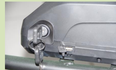
Akku abschließbar mit 5 V - USB - Buchse.
