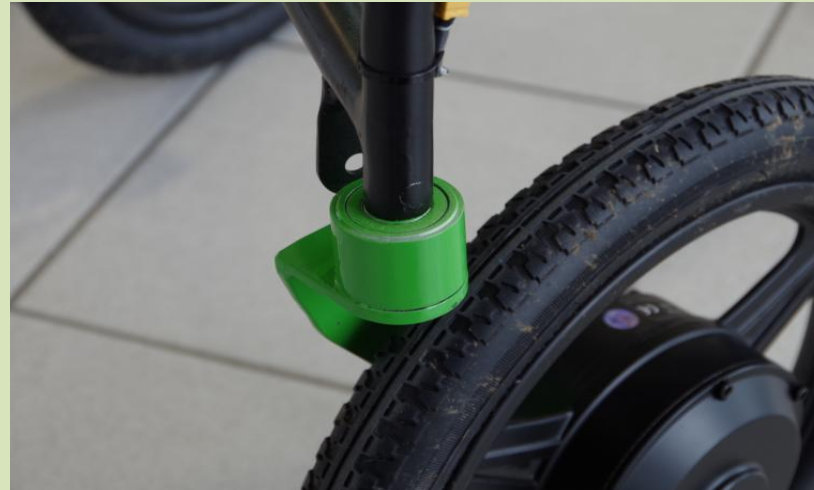
Die vorderen 350 mm Lenkräder besitzen einen zum Patent angemeldeten Hydraulischen Dämpfer gegen das bekannte Aufpendeln der Vorderräder
